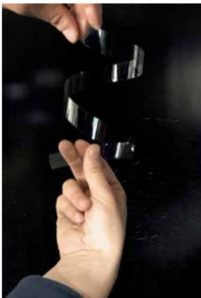
可弯曲的超薄触控玻璃
